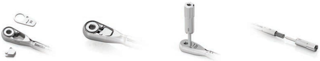
Dopo aver lubrificato le parti indicate in figura, inserire i due elementi che compongono la testa del cricchetto nella seguente sequenza: ruota a nottolino dentellata e successivamente il dente ferma ruota.
