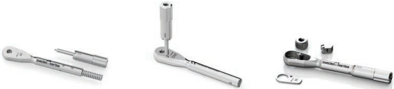
Svitare completamente la vite di regolazione del torque ed estrarre la molla contenuta all'interno del manico del corpo cricchetto. Non separare la molla dal perno che funge da stop.
